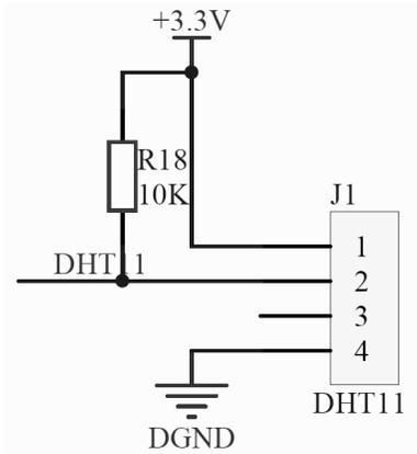
Fig. (4). DHT11 hardware circuit diagram.
