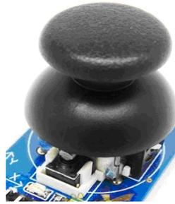
**Fig. (9).** Joystick module.
