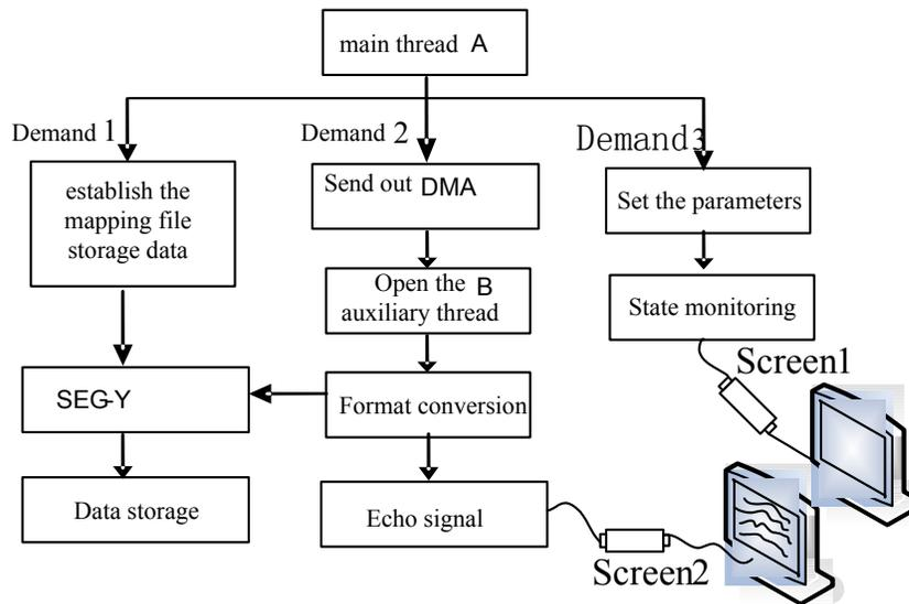
Fig. (4). Software Design Block Diagram.
