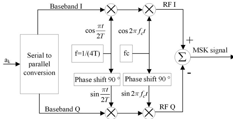
Fig. (3). MSK Modulation.
